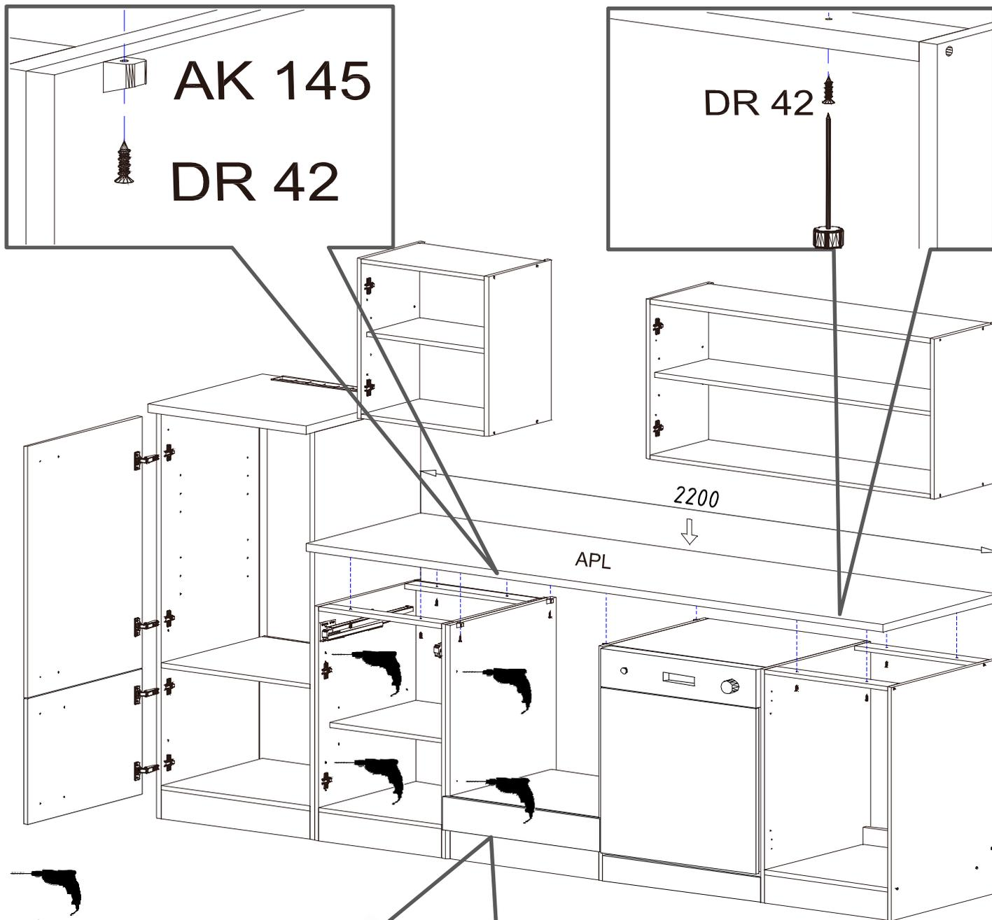
Mit  $\varnothing 5\text{mm}$  Bohrer durchbohren
