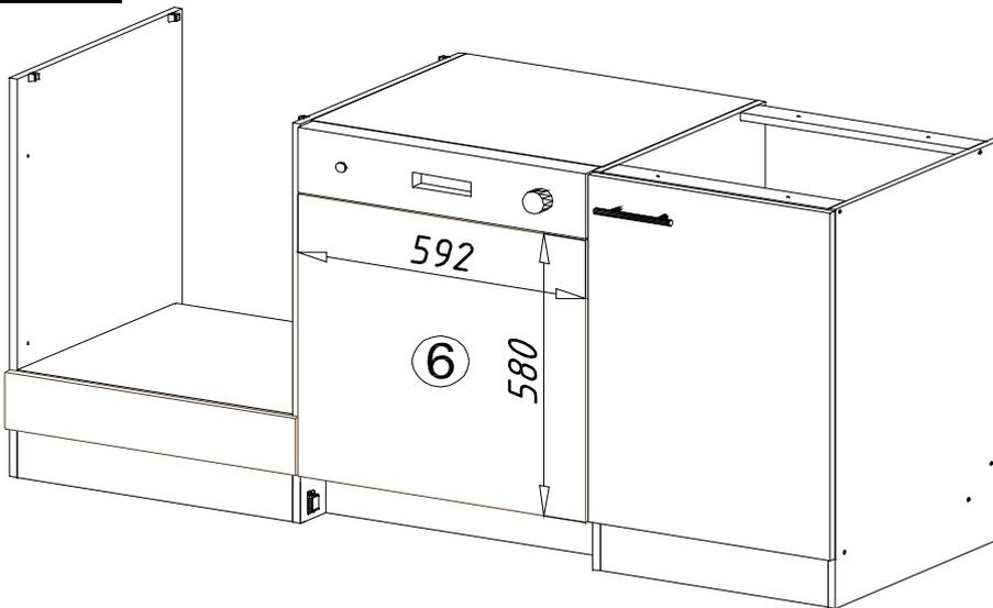
Den Aufbau vom Front sehen Sie in der Bedienungsanleitung vom Geschirrspüler, zur Höhenanpassung Front für Geschirrspüler bitte die beigefügten Distanzleisten verwenden. Diese befinden sich im inneren des Geschirrspülers.
