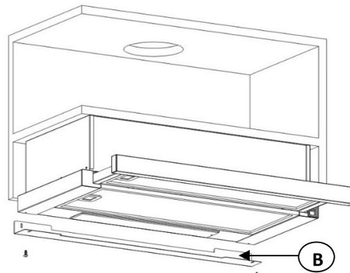
Wenn sich zwischen der Wand und der Dunstabzugshaube ein Spalt (A) befindet, können Sie die L-förmige Halterung (B) mit zwei Schrauben (3 x 12 mm) an der Unterseite der Dunstabzugshaube anbringen. Die Installation der L-förmigen Halterung ist optional.
