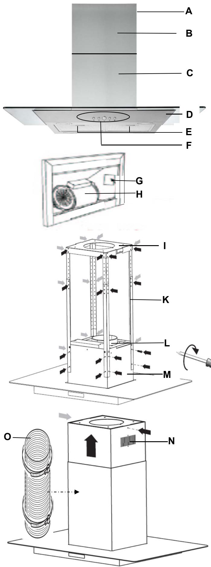
**respekta®****CH 3100 GIS A****A Umluft Austrittsgitter****B Innerer Kaminschacht****C Ässerer Kaminschacht****D Haubenkörper****E Alu Fettfilter****F Bedienpanel****G Typenschild****H Motor****I Montageplatte
