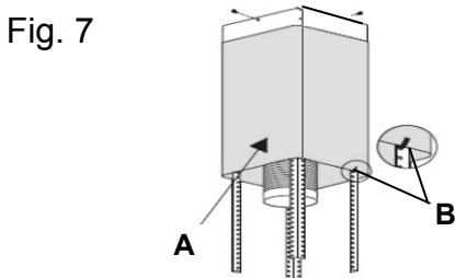
**10.** Den Aussenschacht **A** (Fig. 7) über den bereits festgeschraub-ten Innenschacht ganz nach oben schieben und mit 2 S-Haken **B** (Fig. 7) fixieren, damit der untere Teil der Winkeleisen-Konstruktion für die weiteren Montageschritte zugänglich ist.
